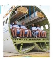
Figure 1 : Fuselage Drop test<sup>4</sup>
